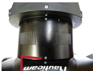
ロックレバーをリリース状態にして ポートとハウジング側の●印の位置 を合わせて押し込む。
